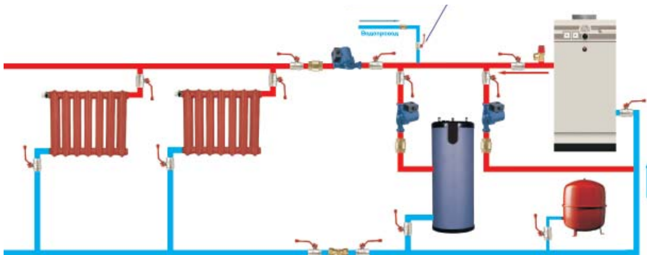
Рисунок 7. Схема подключения котла с принудительной циркуляцией теплоносителя.
