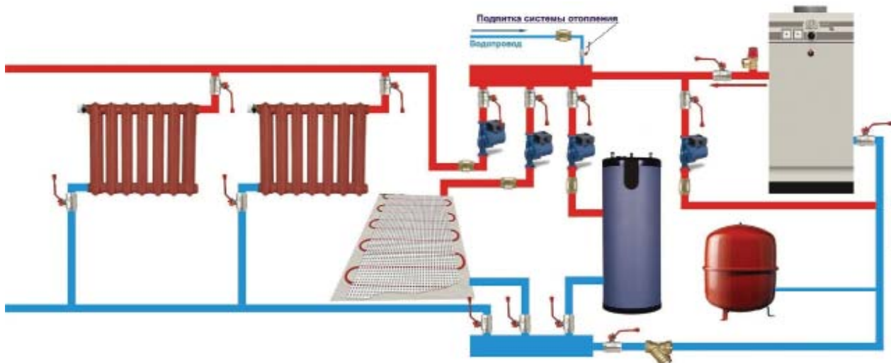
Рисунок 6. Схема подключения котла с общим коллектором.
